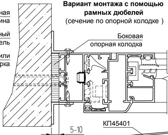
Дюбель F 8 M (F 10 M) фирмы "fischer" диаметром 8 мм (по втулке) с оцинкованным винтом с потайной головкой. Головка винта диаметром 9 мм.
