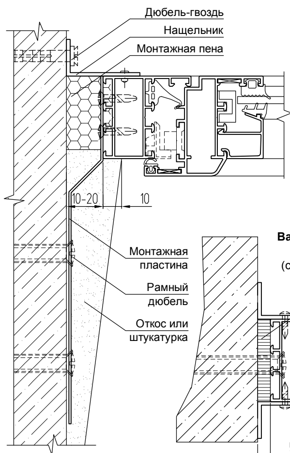
Вариант монтажа с помощью монтажных пластин
